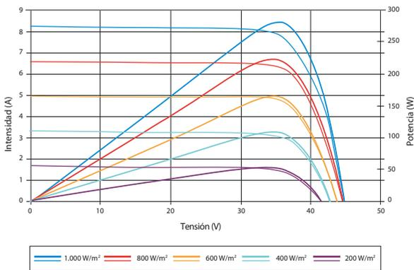
Excelente rendimiento bajo condiciones de luz débil: Con una intensidad de radiación de 200 W/m<sup>2</sup> (AM 1,5, 25 °C), se alcanza el 95,5 % o más de la eficiencia bajo condiciones de prueba STC (1000 W/m<sup>2</sup>)
